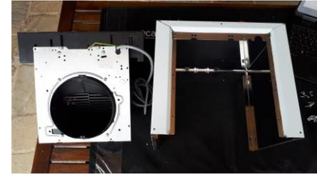
Remove 8 screws and the Earth wirings (2 more screws). Then remove 7 screws and separate motor box from hood frame/ Rimuovere 8 viti + il cablaggio Terra (2 viti in più). Successivamente rimuovere 7 viti. Infine separare il box motore dalla cornice della cappa
