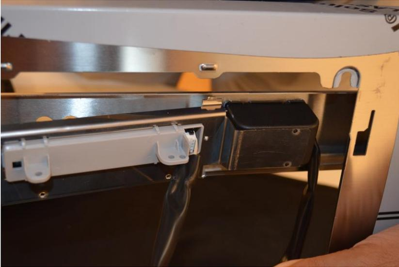
Unscrew the user interface from the frame / togliere le viti fissaggio cruscotto comando dal telaio filtro
