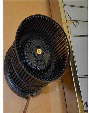
Unscrew 4 external screws to remove conveyor. Remove 4 conveyor screws to get access with motor and fan wheel. Unhook motor connectors from electronic device / Rimuovere 4 viti esterne per sganciare il convogliatore. Rimuovere 4 viti del convogliatore per accedere al motore e alla girante. Rimuovere i cablaggi.
