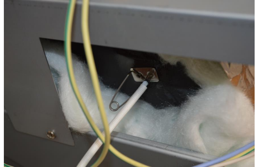
Disconnect electrical connection and remove retaining spring / togliere il collegamento elettrico e sganciare la molla di fissaggio
