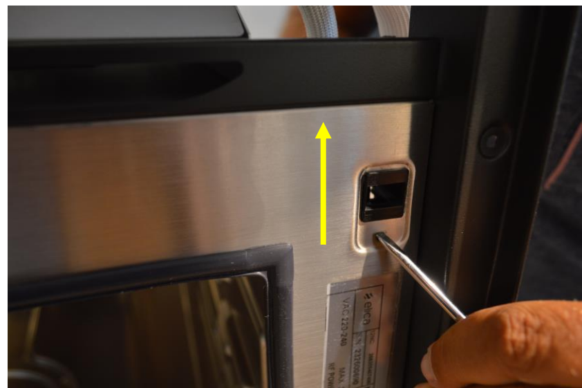
Disconnect electrical connection, press with a screwdriver the security pin and push upwards the switch for release / scollegare collegamento elettrico, premere con un cacciavite il pin di sicurezza e spingere il mirco in alto per il rilascio.
