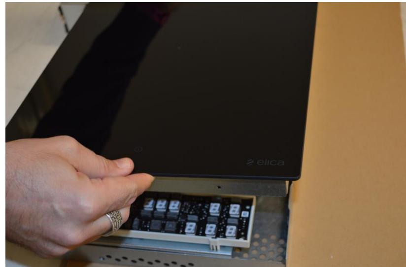
Remove the perimetrical screws to induction module and user interface, lift up der glass cover / rimuovere le viti perimetrali per accedere modulo d'induzione e comandi, sollevare il pannello vetro
