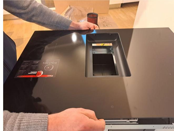
Remove all perimetral screws and pull out glass / rimuovere tutte le viti perimetrali e rimuovere il vetro.
