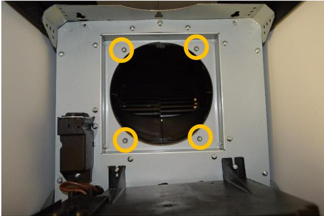
Open n.4 screws from the top to unlock the motor / Rimuovere 4 viti dall'alto per sganciare il motore
