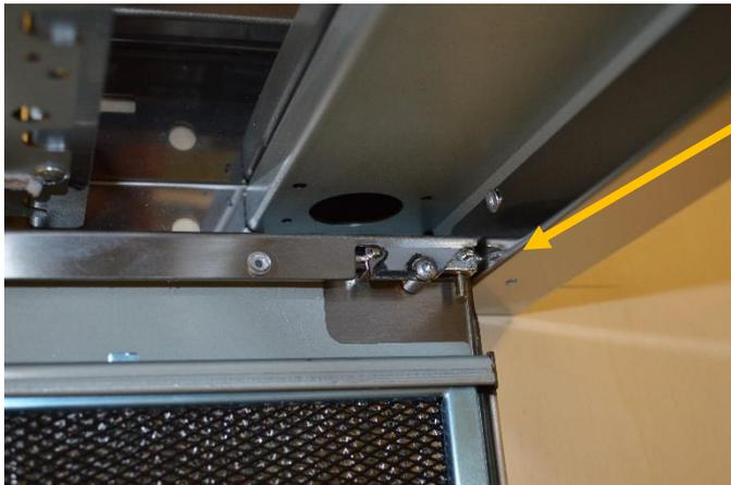
Unlock the hinge to remove the Filter Grill and Grease Filter / Sganciare la cerniera per rimuovere la griglia e i filtri grassi
