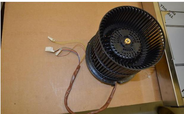
Remove Motor and unscrew fan wheel / rimuovere il motore e liberare la girante
