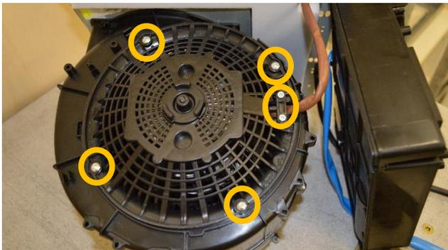
Remove from the below the motor and unscrew n.6 screws / rimuovere dal basso il motore e rimuovere 6 viti
