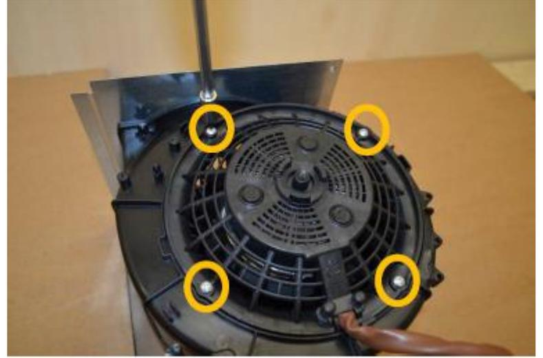
Unscrew 1 screw of the conveyor support to divide it from the conveyor and remove 4 screws to get access to motor / Rimuovere la vite del supporto del convogliatore per dividerlo dal convogliatore. Successivamente rimuovere 4 viti per accedere al motore
