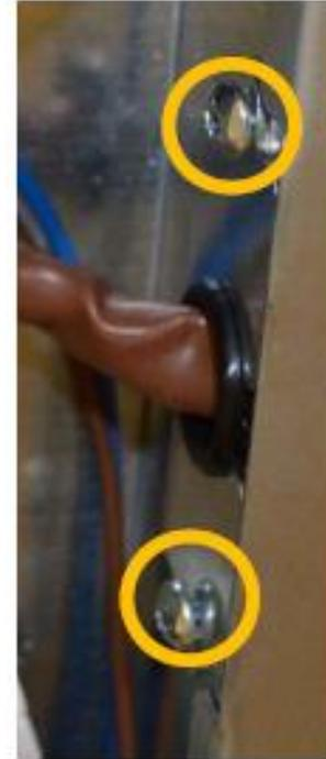
Remove internal protection bracket, unscrewing 2 screws / Rimuovere la staffa interna, rimuovendo 2 viti
