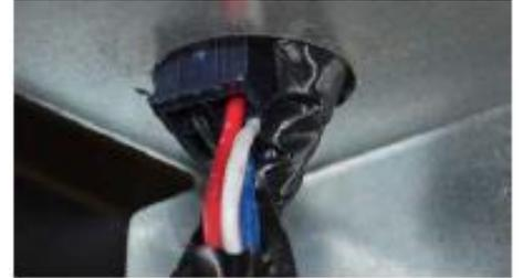
Unhook the wire locker and remove LED connector / Sganciare il fissacavo e rimuovere il connettore LED
