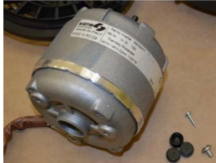
Remove 3 protection cap from motor support / Rimuovere i 3 coperchi dal supporto motore
