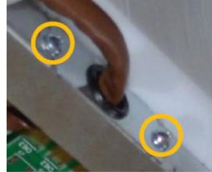
Remove external protection bracket unscrewing 2 screws / Rimuovere la staffa esterna, rimuovendo 2 viti
