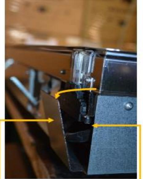
User Interface LED NB. To replace the LED indicator the hood must be removed from ceiling / UI indicatore LED. NB. Per sostituire l'indicatore LED è necessario rimuovere la cappa dal soffitto. Aprire la protezione in metallo piegandola leggermente senza danneggiarla, in seguito alla riparazione riposizionarla correttamente. Rimuovere 2 viti e rimuovere l'indicatore LED.
