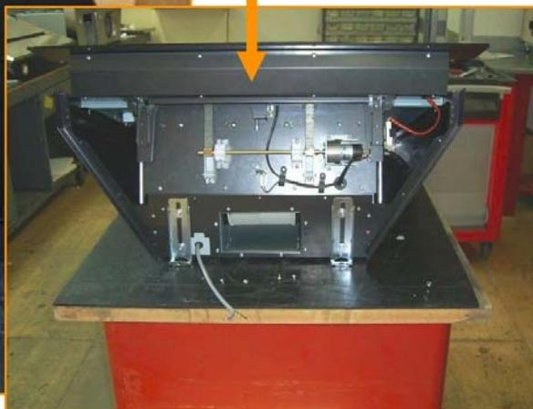
Per sostituire il vetro è necessario rimuovere sia le viti laterali che tutto il vano lampade.
