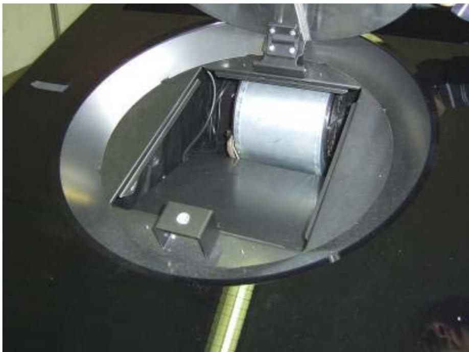
I componenti all'interno sono gli stessi del vecchio modello. Aggiunto un coperchio in lamiera per la copertura delle due scatole elettronica.
