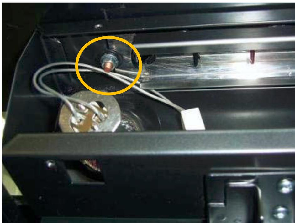
Rimosso il pannello, se è necessario sostituire il vetro, togliere le due viti indicate a sinistra e destra.
