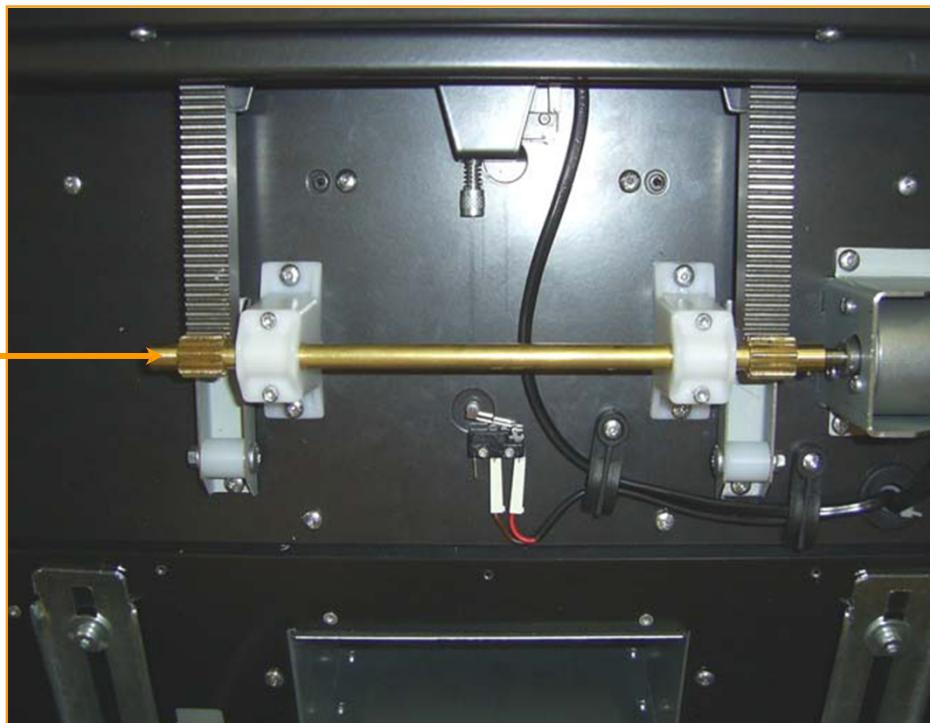
Albero in ottone apertura vano lampade (fornito come parte di ricambio)
