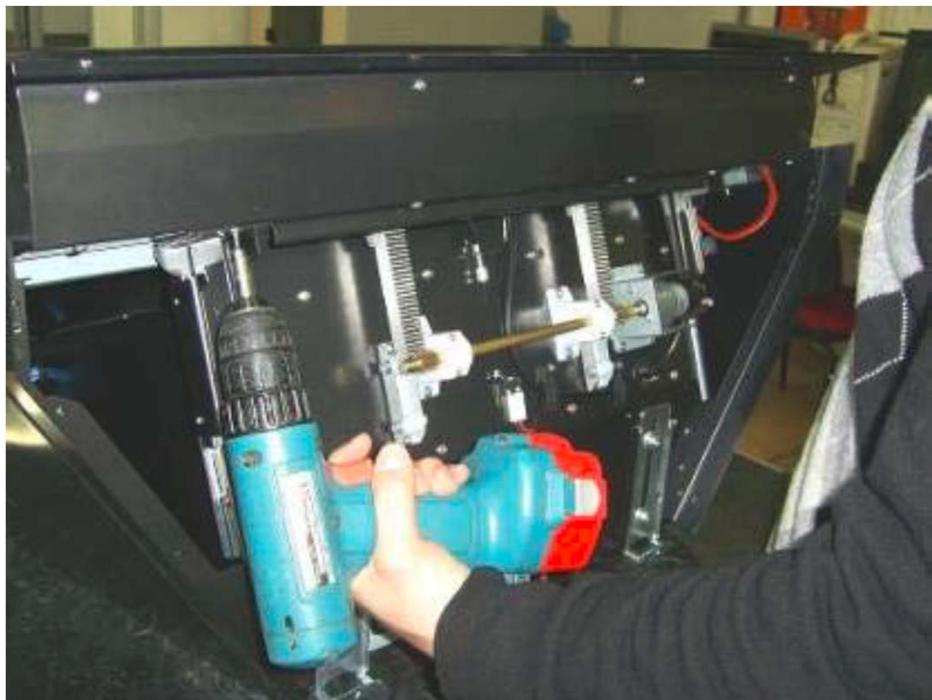
Rimozione pannello superiore per sostituzione guide laterali
