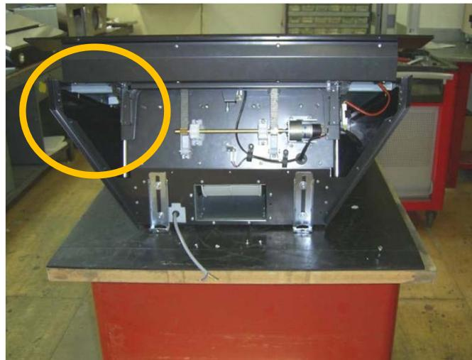
Per sostituire i comandi è sufficiente togliere le viti laterali e poi estrarre il cruscotto dalla parte superiore. Non è necessario rimuovere il vetro.
