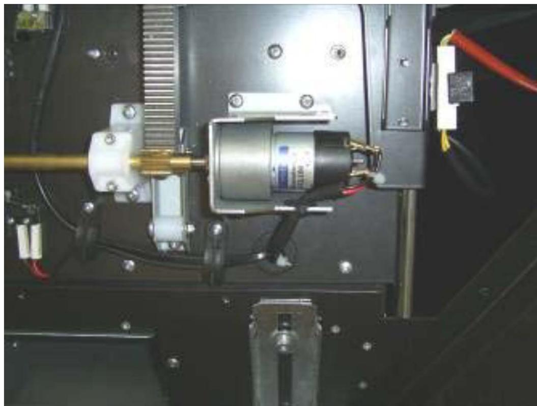
Motore apertura vano lampade
