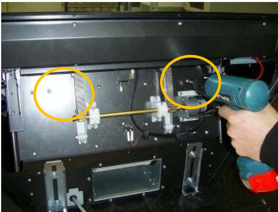
Rimozione pannello interno per sostituzione guide laterali.
