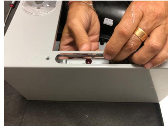
Remove the screw and pull out the user interface / rimuovere la viti ed estrarre il comando
