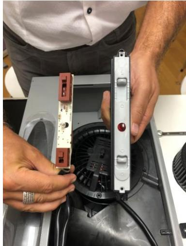
Complete user interface replacement as indicated by wiring diagram / Completare la sostituzione del comando come indicato nello schema elettrico.
