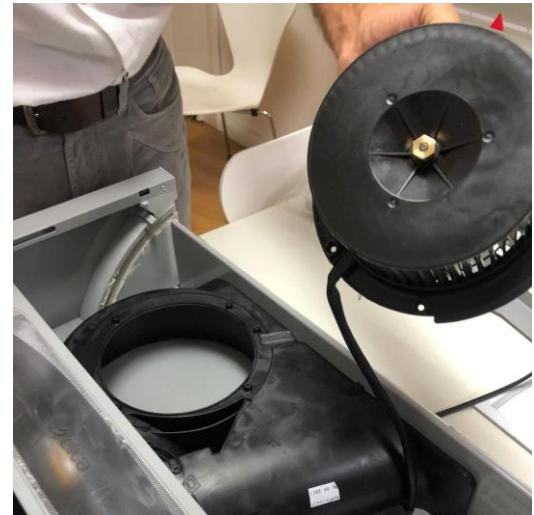
Remove 2 protection caps and 5 screws and pull out fan wheel and motor / Rimuovere 2 tappi di protezione e 5 viti ed estrarre il motore
