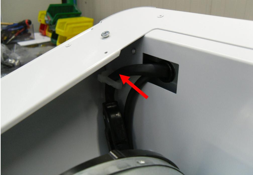
Fissare nel passacavo inferiore entrambi i cablaggi (vedi foto).
