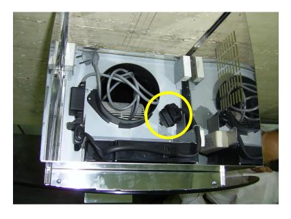
Remove the fixing spring to release the blower from inside. Disconnect the power supply for the motor / Rimuovere la molla di fissaggio per liberare il soffiatore dall'interno. Scollegare l'alimentazione del motore
