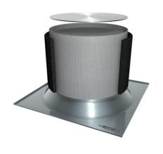
The carbon filter is applied externally to the grease filter. The filter must be fixed with 3 filter clips. A steel closure must be inserted in the upper part to prevent air from escaping from the upper part/ Il filtro al carbone è applicato esternamente al filtro antigrasso. Il filtro va fissato con 3 ferma filtri. Nella parte superiore va inserita una chiusura d'acciaio per impedire che l'aria fuoriesca dalla parte superiore
