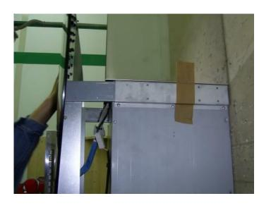
Press the glass panel backwards to be closed completely. Secure with fixing screws / Premere il pannello di vetro all'indietro per chiuderlo completamente. Fissare con le viti di fissaggio
