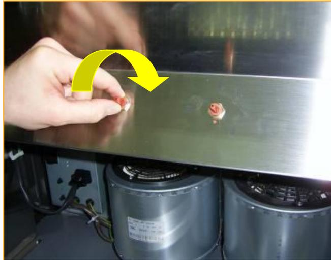
Fixing nut with a view of the holding pin. Remove the nut to free the control box from the body. / Dado di fissaggio con vista del perno di tenuta. Rimuovere il dado per liberare la scatola comandi dal cassone
