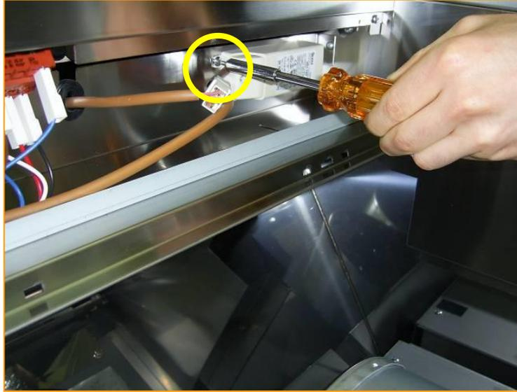
Remove the screw / rimuovere la vite
