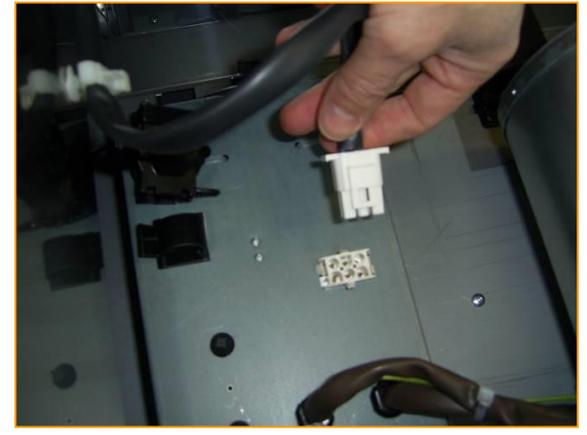
Remove the protective shell of the connector by pressing sideways with a screwdriver / Rimuovere il guscio di protezione del connettore premendo lateralmente con un giravite
