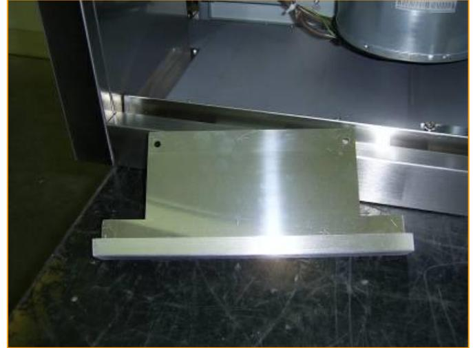
To remove the grease tray, remove 2 screws / Per estrarre la vaschetta raccogli grasso, rimuovere le 2 viti
