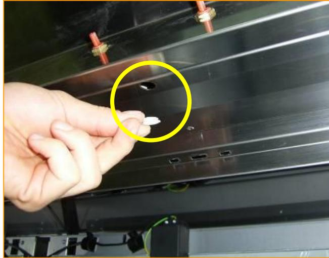
Remove the screws inside the box. Remove the cap that allows the removal of the other support screws / Rimuovere le viti riportate all'interno del cassone. Rimuovere il tappo che permette la rimozione delle altre viti di sostegno.
