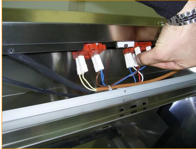
Remove the control box by acting directly on the connections. / Rimuovere la scatola comandi intervenendo direttamente sulle connessioni
