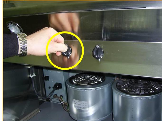
Remove grease filters. Extract the aesthetic knob by exerting a slight pressure in the direction indicated. Use rubber tape / rimuovere griglie filtro. Estrarre la manopola estetica esercitando una leggera pressione nel verso indicato. Utilizzare nastro gommato.
