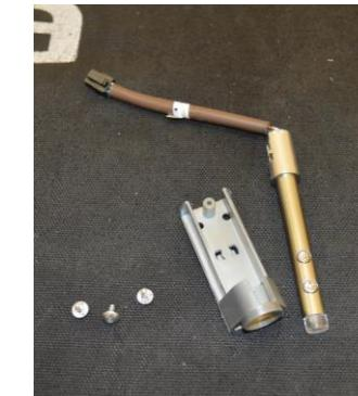
User interface of these hoods is MAGIC WAND, code KIT02601. In order to remove magic wand unhook from its seat releasing the lever. Alternatively it's possibile the remove 3 back screws but in this case also support is released / Il comando di questi modelli di cappa è il MAGIC WAND, codice KIT02601. Al fine di rimuoverlo dalla sede sganciare la levetta. In alternativa ci sono 3 viti posteriori, rimuovendo le 3 viti viene sganciato anche il supporto
