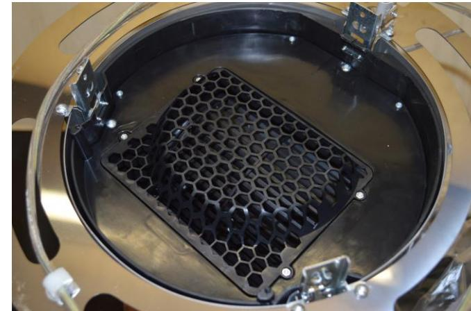
Motor is assembly as a KIT. Make connections like the old motor / il motore è assemblato come un assieme. Rifare i collegamenti come il motore montato precedentemente
