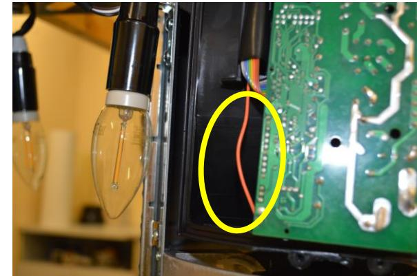
Rotate main board. Take care antenna of remote control / Ruotare la scheda. Fare attenzione all'antenna per telecomando
