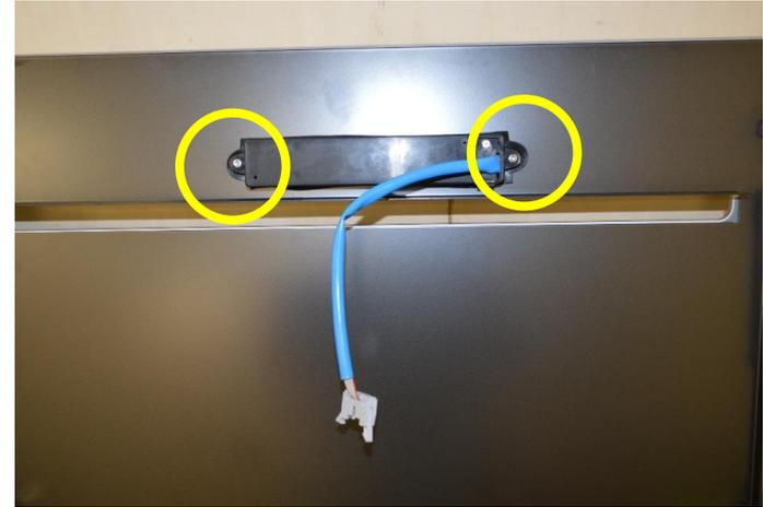
Disconnect UI connection, and unscrew n.2 screws. After that it's possible to get access with and replace the UI. / Disconnettere il connettore dell'UI e rimuovere le 2 viti. Dopodichè è possibile accedere e sostituire l'UI
