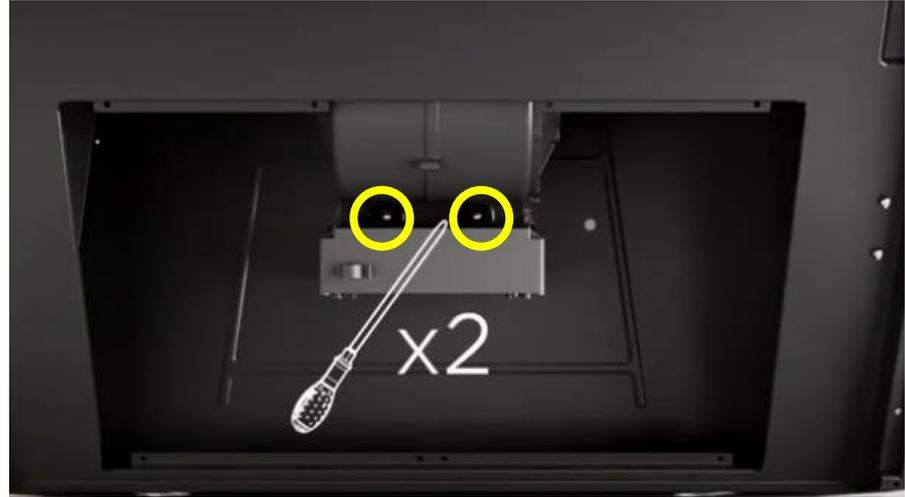
In case of back aspiration, remove 4 superior screws and 2 inside the product / In caso di back aspiration rimuovere le 4 viti superiori e le 2 viti interne
