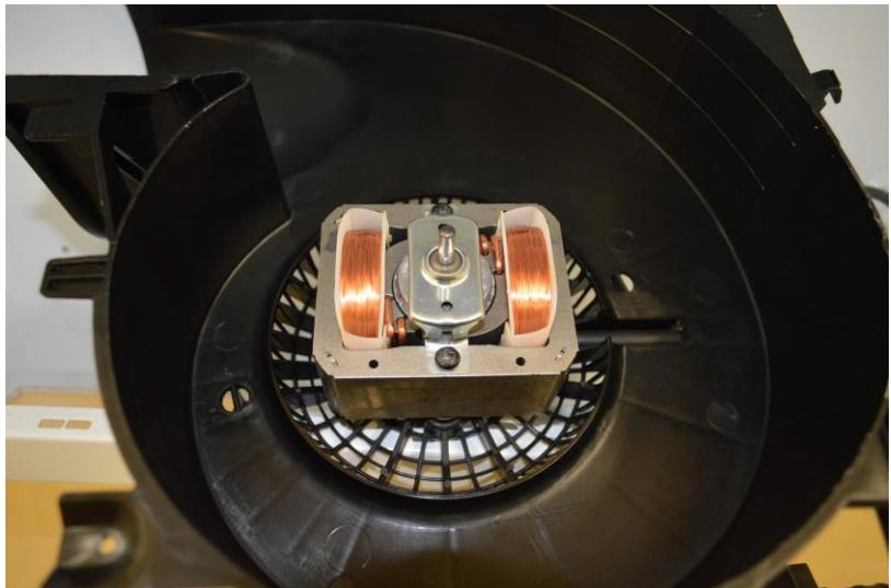
Remove protection caps and the remove screws / rimuovere i cappucci di protezione e successivamente le 2 viti
