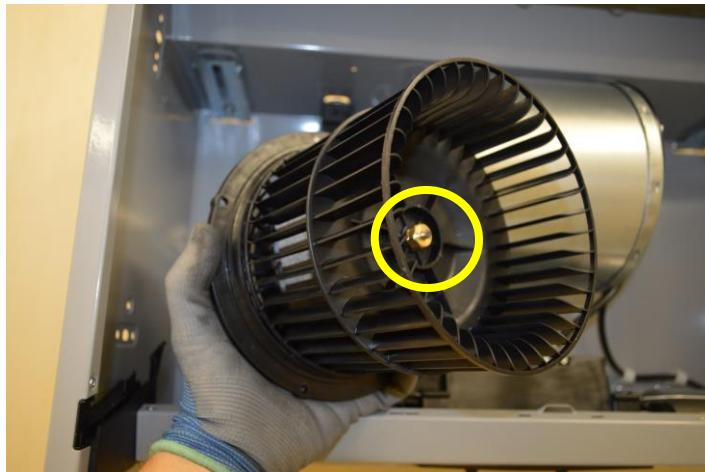
Remove the nut of the conveyor and replace motor / rimuovere il dado della girante e sostituire il motore
