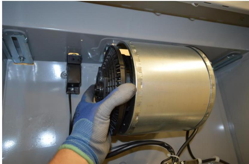
There is 2 different versions of INTEGRATA hood. Another has a different motor. Remove 4 lateral screws and pull out motor from its seat / Ci sono 2 versioni di cappa INTEGRATA. Un'altra ha un tipo di motore diverso. Rimuovere le 4 viti laterali ed estrarre il motore dalla sede
