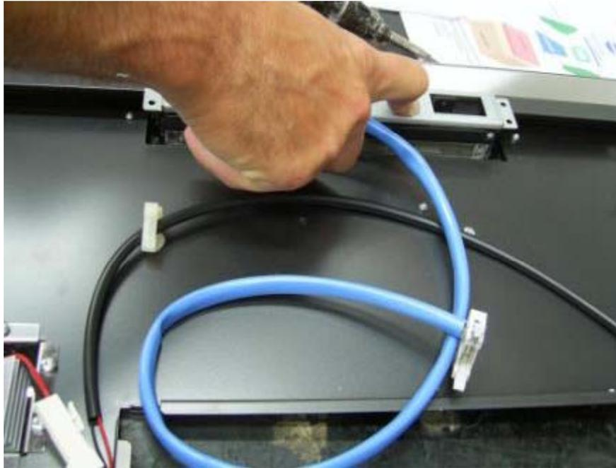
Per sostituire la scheda comandi è necessario rimuovere il vetro anteriore. Togliendo le viti nella parte superiore è possibile rimuovere il vetro
