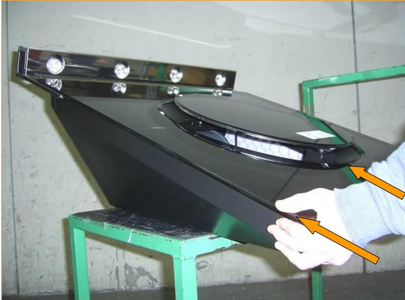
Push upwards and then raise the glass / spingere il vetro verso l'alto per rimuoverlo
