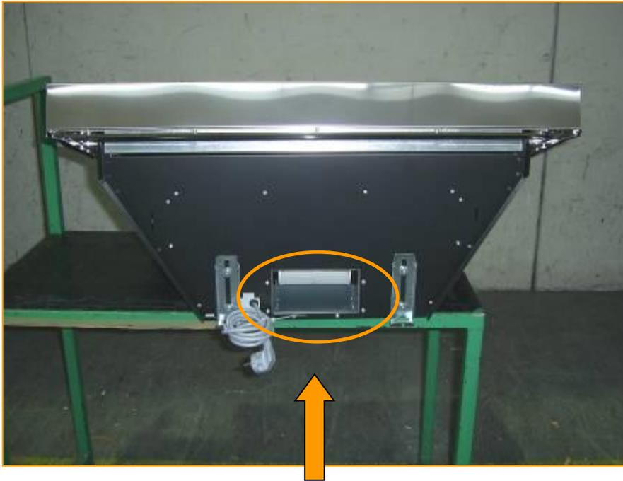
There are 6 screws fixing the motor on the shell of the cooker hood / nella parte superiore del prodotto ci sono 6 viti per fissare il motore
