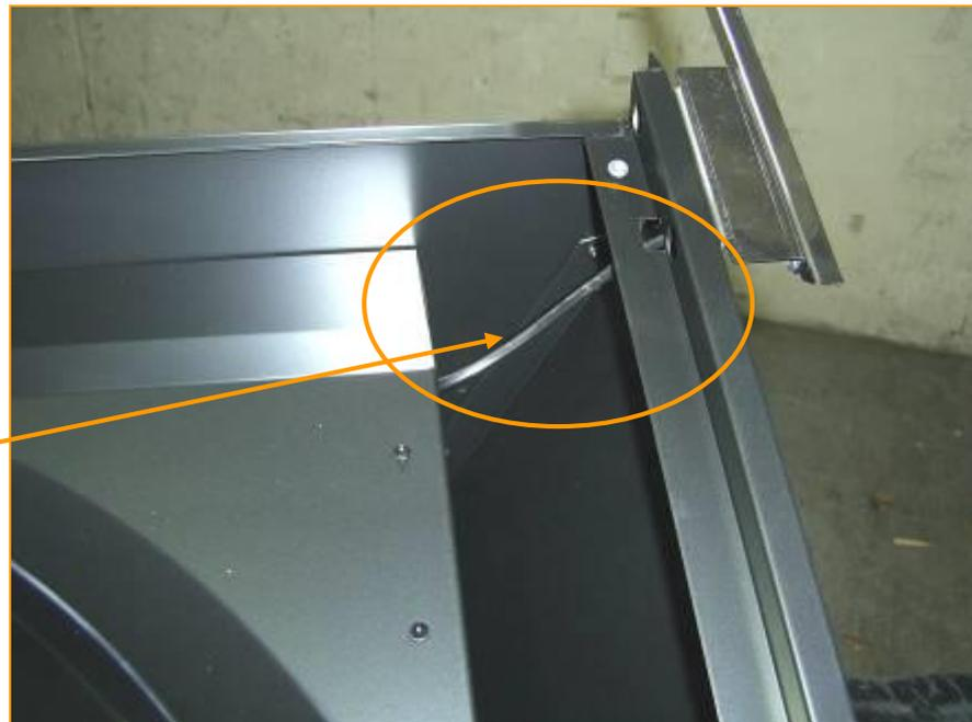
Remove the wiring cable without the faston / rimuovere il cablaggio senza faston
