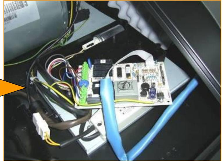
After removed the grease filter, you find the electronic box. The electronic board is within the box /Dopo aver rimosso il filtro antigrasso, trovi la scatola elettronica. La scheda elettronica è all'interno della scatola.
