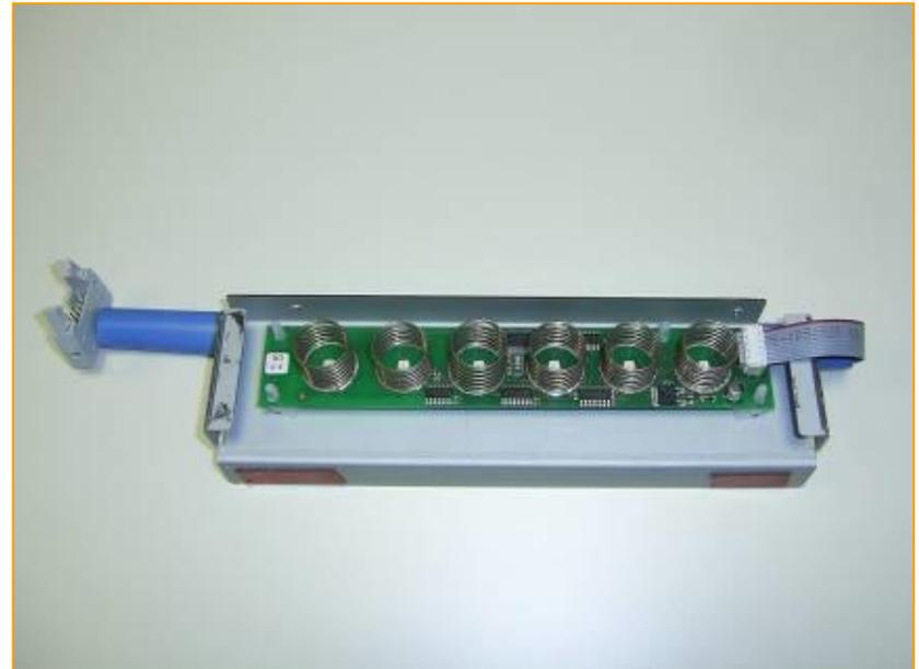
It is useful, checking that the capacitive spring keeps in touch with the glass. It is possible to do this operation by hand / È utile verificare che la molla capacitiva rimanga a contatto con il vetro. È possibile eseguire questa operazione manualmente
