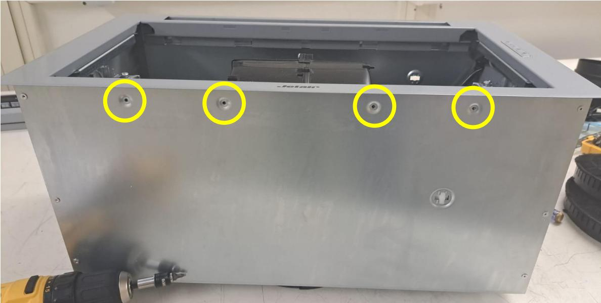
Unscrew nr. 12 the fixing screws to release the inner frame / Svitare nr.12 viti di fissaggio per sbloccare il telaio interno
