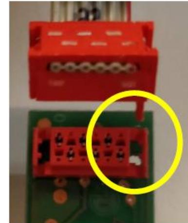
Cut off the binder and disconnect the match connector to replace the UI. Be carefull when replace the user interface, match the hole and the correct pin / Tagliare la fascetta e scollegare il connettore del comando per sostituire l'interfaccia utente. Attenzione a inserire il comando nel verso giusto quando viene sostituito.
