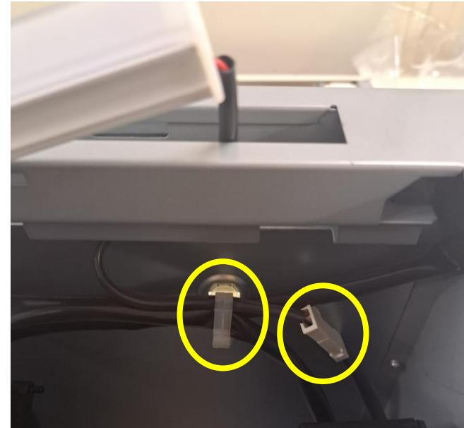
Open front panel; pull out lamp from its seat using a screwdriver. Be carefull to don't damage external frame. Then disconnect lamp wiring / aprire il pannello frontale; rimuovere con un giravite la lampada dalla sede. Fare attenzione a non rovinare la cornice esterna. Infine rimuovere la connessione della lampada
