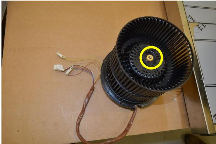
Remove the nut of the fan wheel and replace motor (other 4 screws to separate also the plastic motor support) / Rimuovere il dado della girante e sostituire il motore (ci sono altre 4 viti interne da rimuovere per separare un ulteriore supporto in plastica).
