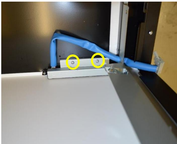
Unscrew the 2 fixing screws and remove the user interface / Svitare le 2 viti di fissaggio e rimuovere l'interfaccia utente
