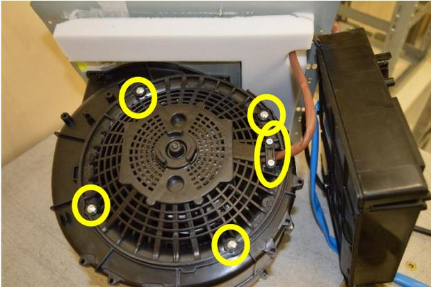
Unscrew the fixing screws of the motor support and the fixing screws of the sleeve holder / Svitare le viti di fissaggio del supporto del motore e le viti di fissaggio del portaguaina
