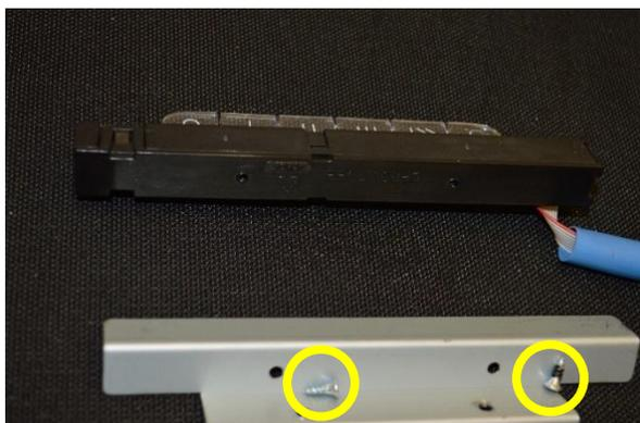
When fixing the support bracket take care of the correct position / Durante il fissaggio della staffa di supporto, assicurarsi che sia nella posizione corretta
