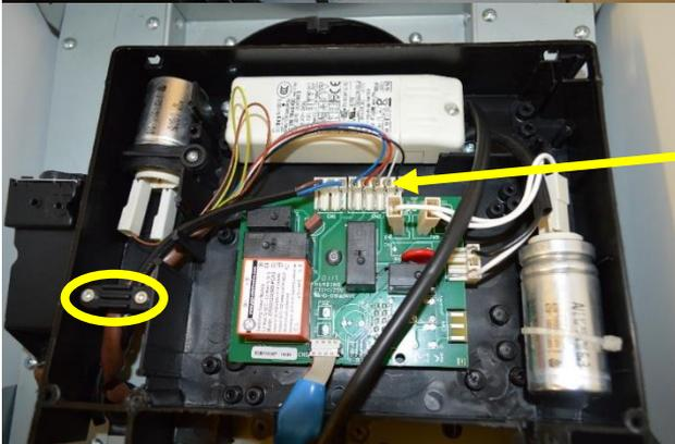
Open the electronic device, remove the fixing cable and disconnect the Motor Connector / Aprire il dispositivo elettronico, rimuovere i cavi di fissaggio e disconnettere il connettore del motore
