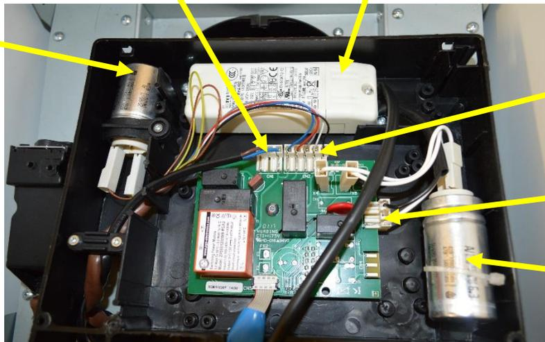
Motor Connector / Connettore del motore
