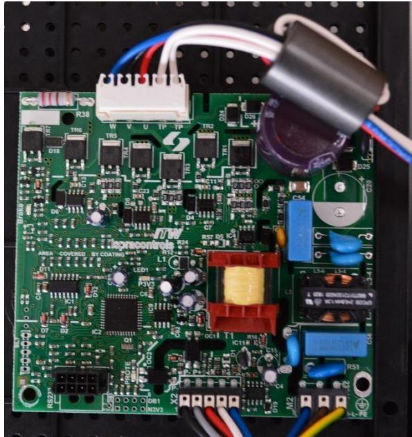
La carte contrôle la fonctionnalité du moteur brushless, recevant les commandes de la carte d'aspiration. 3 connexions sont disponibles : connexion moteur, connexion alimentation (L-N-terre) et connexion communication. Directement sur la carte, il y a 2 LED : une avec une lumière rouge et l'autre avec une verte. La LED rouge, en cas de dysfonctionnement, fait un certain nombre de clignotements, ce qui correspond aux types de problème suivants:
