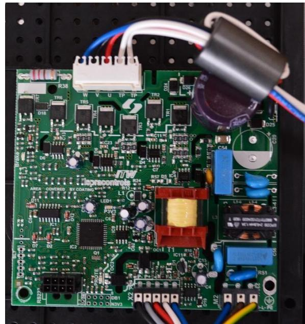
La scheda controlla la funzionalità del motore brushless, ricevendo i controlli dalla scheda di aspirazione. Sono disponibili 3 connessioni: connessione motore, connessione alimentazione (L-N-terra) e connessione comunicazione. Direttamente sulla scheda sono posizionati 2 led: uno con luce rossa e l'altro con uno verde. Il led rosso, in caso di malfunzionamento, fa un determinato numero di lampeggi, ciò significa comunicare il tipo di problema:
