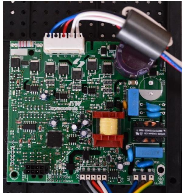
Die Platine des Absaugsystems steuert die Platine des Brushless-Motors. Es gibt 3 Anschlüsse: Motoranschluss, Stromanschluss (L-N-Masse) und Kommunikationsanschluss. Direkt auf der Platine befinden sich 2 LEDs: eine mit rotem Licht und die andere mit grünem Licht. Die rote LED blinkt im Fehlerfall eine bestimmte Anzahl von Blinken, das bedeutet, dass folgendes Problem mitgeteilt wird:
