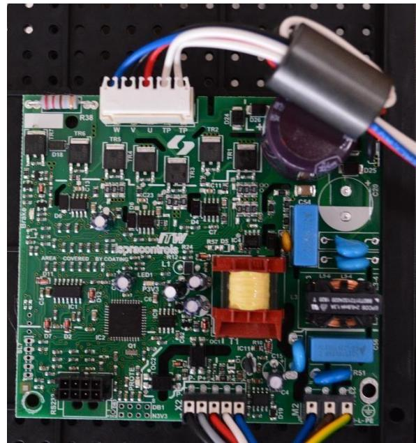
La tarjeta controla la funcionalidad del motor sin escobillas, recibiendo los controles de la tarjeta de aspiración. Hay 3 conexiones: conexión del motor, conexión de alimentación (L-N-tierra) y conexión de comunicación. Directamente en la placa hay 2 LED: uno con luz roja y otro con verde. El LED rojo, en caso de avería, hace un cierto número de parpadeos, esto significa que comunica el tipo de problema:
