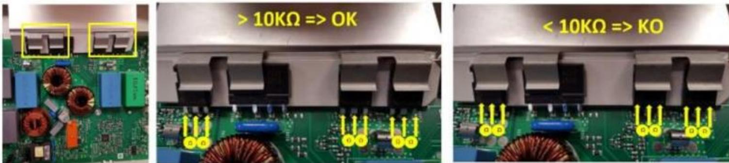
6. Se i valori IGBT verificati in precedenza sono ok, sostituire la scheda principale.
