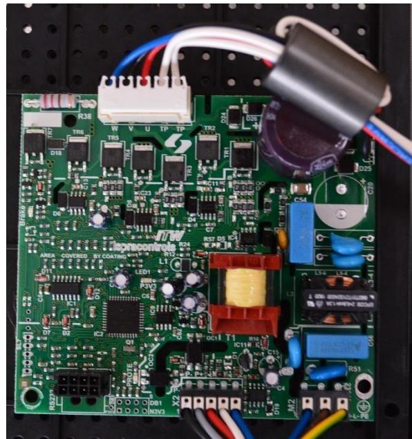
Karta steruje funkcjonowaniem silnika bezszczotkowego i otrzymuje polecenia z karty pochłaniania. Są możliwe 3 połączenia: połączenie silnika, połączenie zasilania (L-N-uziemienie) i połączenie łączności. Bezpośrednio na karcie znajdują się 2 diody Led: jedna ze światłem w kolorze czerwonym a druga zielonym. W przypadku nieprawidłowego funkcjonowania czerwona dioda Led wykonuje określoną liczbę mignięć czyli sygnalizuje rodzaj problemu:
