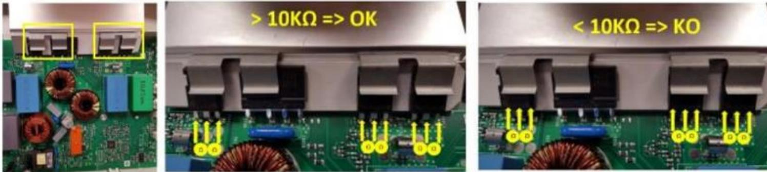
4. Se punti precedenti sono ok, scollegare il connettore evidenziato sulla scheda principale. Se compare errore D1 su user interface della zona aspirazione (zone cottura funzionanti ma aspirazione no con errore D1) sostituire la scheda principale. Se non compare D1 ripetere le operazioni sopra indicate partendo dal punto 1.
