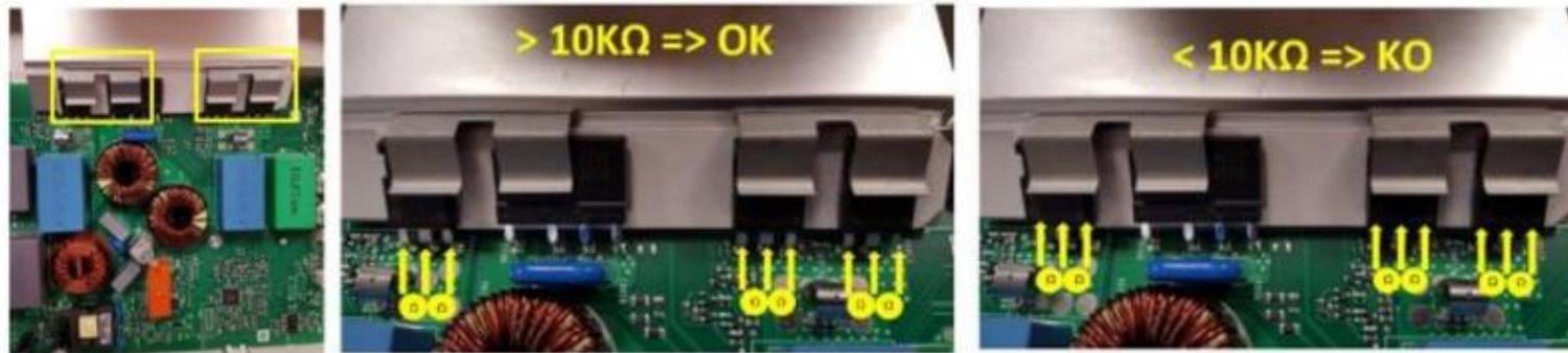
4. Si los puntos principales están bien, desconecte el conector resaltado en la placa principal. Si aparece el error DI en la interfaz de usuario de la zona de succión (las zonas de cocción funcionan, pero la succión no tiene el error DI), reemplace la placa principal. Si no aparece DI, repita las operaciones anteriores comenzando desde el punto 1.
