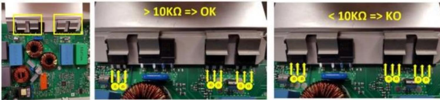
4. Jeżeli poprzednie punkty są prawidłowe, odłączyć złącze zaznaczone na płycie głównej. Jeżeli na interfejsie użytkownika strefy pochłaniania wyświetli się błąd D1 (strefy gotowania działają, ale pochłanianie nie działa, błąd D1) wymienić płytę główną. Jeżeli D1 się nie wyświetli, powtórzyć wskazane wyżej czynności, zaczynając od punktu I.
