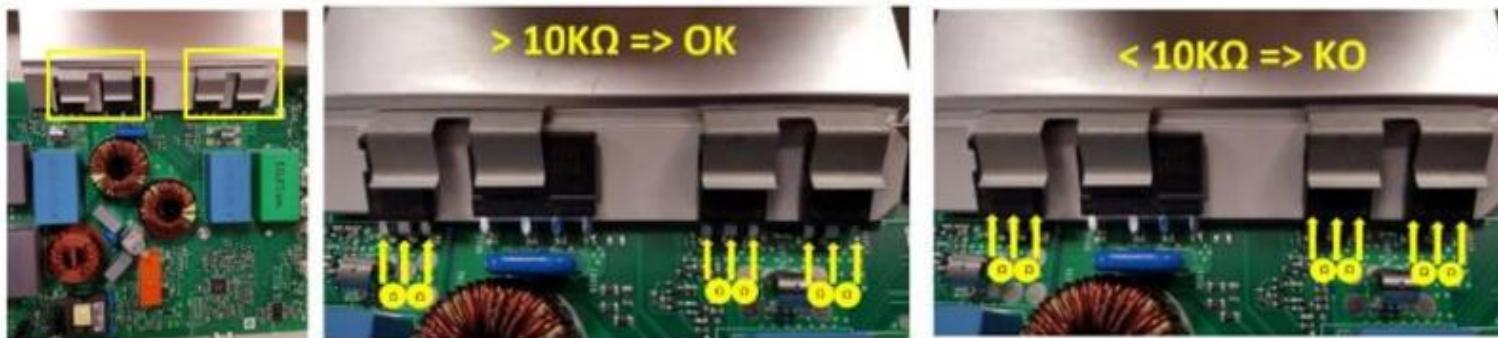
4. Sind alle vorgenannten Eingriffe OK, trennen Sie den auf der Hauptplatine markierten Verbinder. Wenn die Benutzerschnittstelle des Ansaugbereiches den Fehler D1 anzeigt (Kochzonen funktionieren, aber nicht die Absaugung), ersetzen Sie die Hauptplatine. Wird der Fehler D1 nicht angezeigt, wiederholen Sie die obigen Schritte ab Punkt 1.
