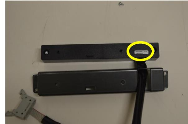
Disconnect UI connection, and unscrew n.2 screws. After that remove other 2 screws and separate UI from its support. There is a label on the back of the control where the code and week/year of production of the spare part are indicated / Disconnettere il connettore dell'UI e rimuovere le 2 viti. Dopodichè rimuovere ulteriori 2 viti per sganciarlo dal suo supporto di plastica. È presente etichetta sul retro dell'comando dove indicato codice e settimana/anno di produzione del ricambio
