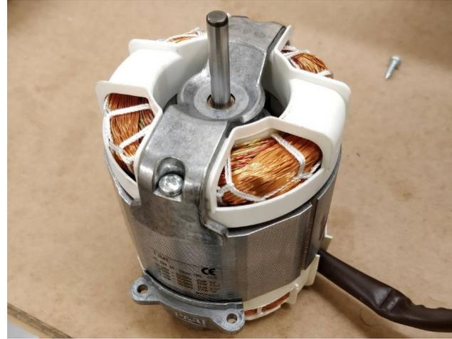
Unscrew 4 fixing screws and replace motor / Rimuovere le 4 viti e sostituire il motore
