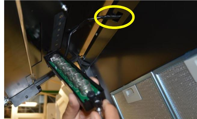
Unscrew 2 screws, pull out UI. Remove grease filters and unhook wiring / Rimuovere le 2 viti e tirare il comando. Rimuovere I filtri grassi e sganciare il connettore
