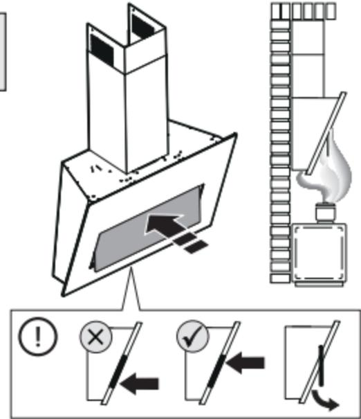
In the case of high heat cooking it is recommended to open flap front panel, otherwise it can remain closed / In caso di cottura a fuoco alto è consigliato aprire il pannello frontale flap altrimenti può rimanere chiuso.
