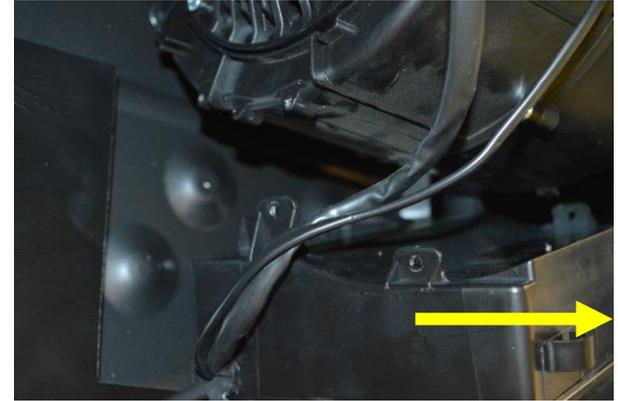
Unscrew 2 screws and pull out electronic box / Rimuovere 2 viti ed estrarre la scatola elettronica
