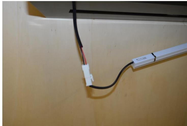
Remove LED and unhook wiring. To help you remove it from the seat, it is recommended to use a slotted screwdriver / Rimuovere la barra LED e sganciare la connessione. Per aiutarti nella rimozione è consigliato utilizzare un giravite a taglio.
