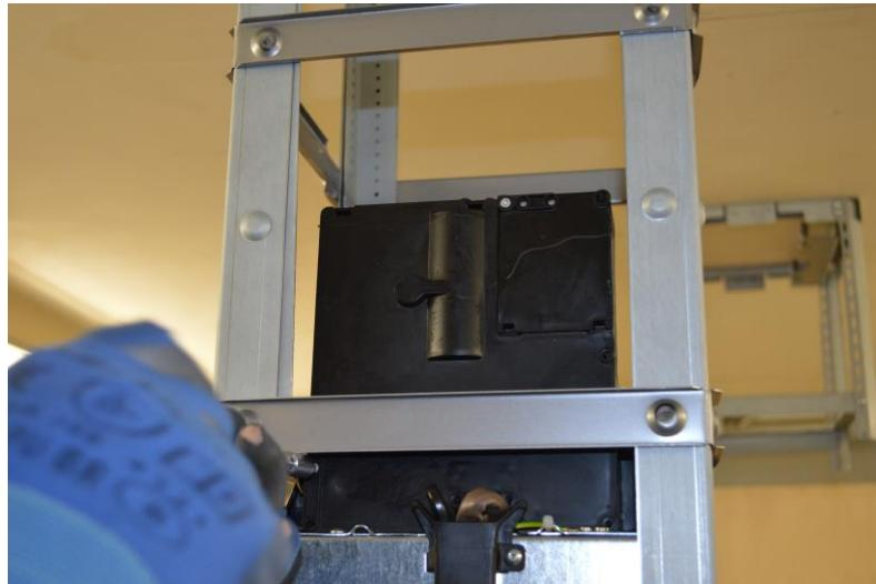
Remove all screws to remove electronic box and get access with electronic device / Rimuovere tutte le viti per rimuovere la scatola elettronica e accedere con un dispositivo elettronico
