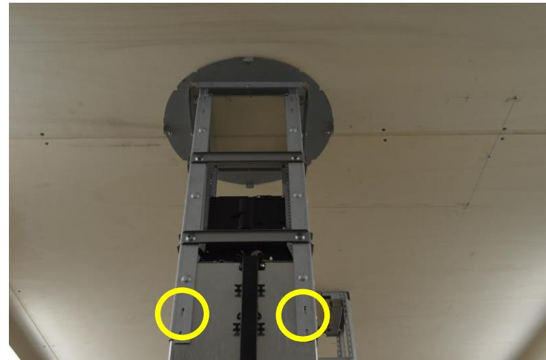
Remove all screws (from all sides) to unhook the motor unit from the trestle / Rimuovere tutte le viti (da tutti i lati) per sganciare l'unità motore dal cavalletto
