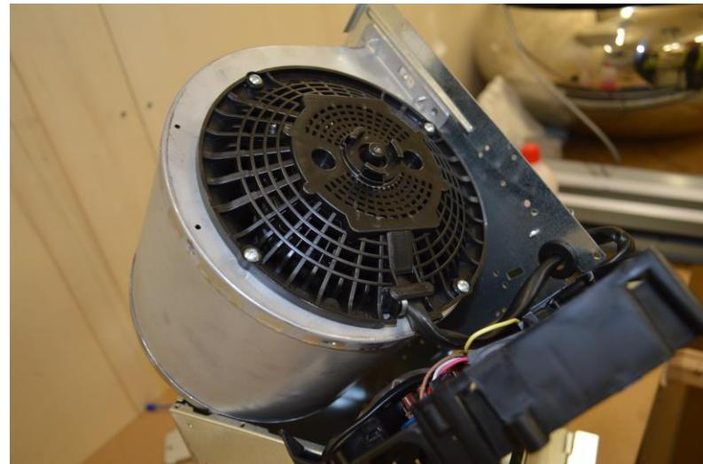
Remove all superior screws to get access with the motor. Then remove motor from the hood / Rimuovere tutte le viti superiori per accedere al motore. Quindi rimuovere il motore
