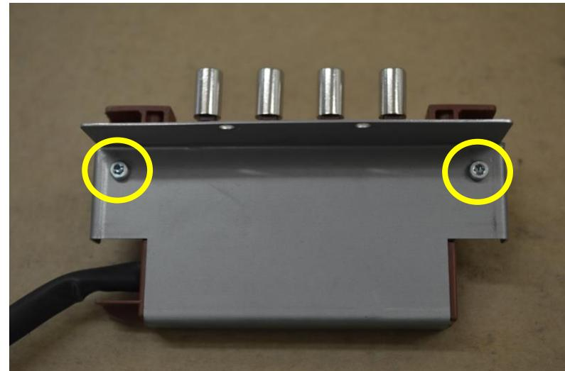
Remove screws to unhook USER INTERFACE from its seat. First remove push button protection and then unscrew 2 screws / Rimuovere le viti per sganciare INTERFACCIA UTENTE dalla propria sede. Rimuovere prima la protezione del pulsante, quindi svitare 2 viti
