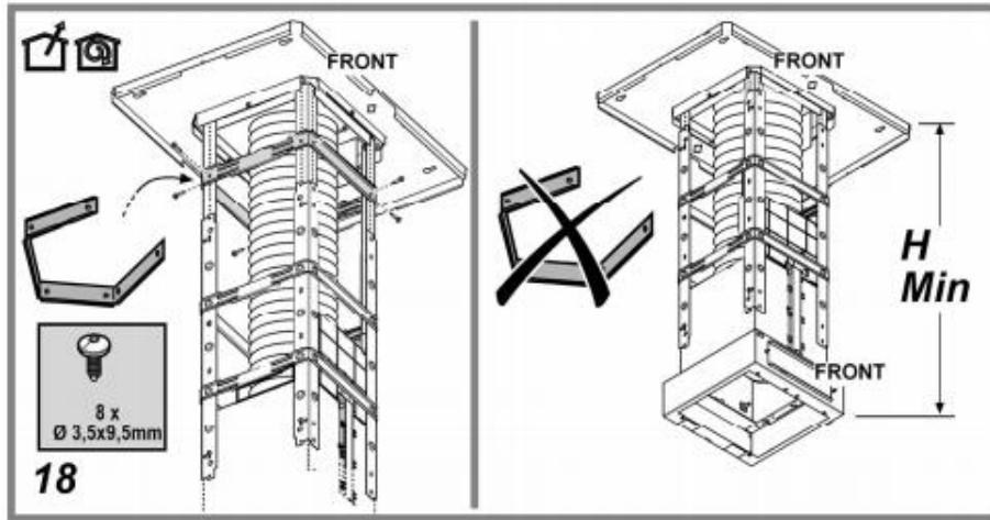
For a correct installation, and to mount the product at the desired height, follow the information on the installation manual / Per un'installazione corretta e per montare il prodotto all'altezza desiderata, seguire le informazioni sul manuale di installazione
