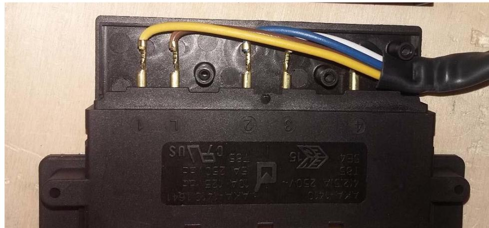
Unscrew n. 3 screws to open the UI box. Remove the fastons and replace UI / Svitare n. 3 viti per aprire la scatola dell'interfaccia utente. Rimuovere i faston e sostituire l'interfaccia utente
