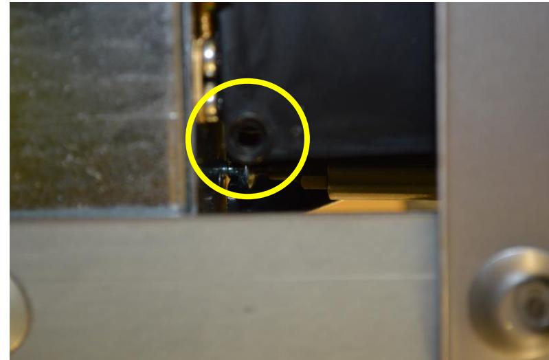
To open the box fold it slightly by loosening the 2 side screws. Then remove all screws to access with electronic device / Per aprire la scatola, piegarla leggermente allentando le 2 viti laterali. Quindi rimuovere tutte le viti per accedere con un dispositivo elettronico.
