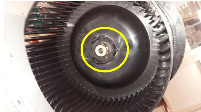
Before remove all screws and then unscrew the nut to get free the impeller / Prima di rimuovere tutte le viti e poi svitare il dado per liberare la girante
