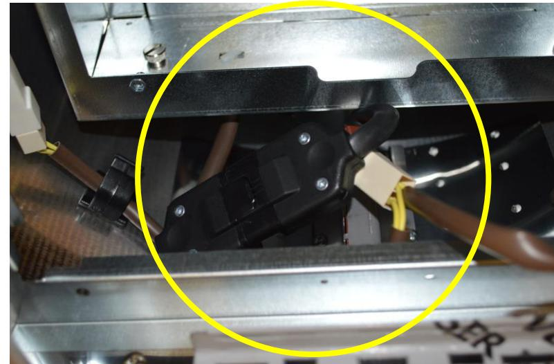
After opening of service panel complete the installation with the connection of wirings / Dopo l'apertura del pannello di servizio, completare l'installazione con il collegamento dei cablaggi
