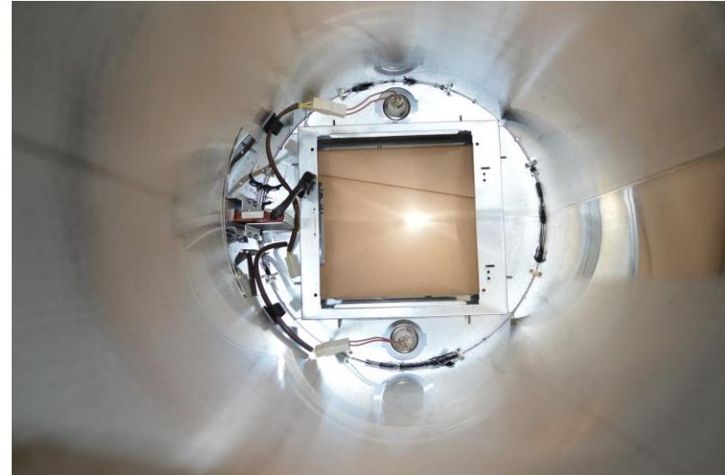
ATTENTION: From now all replacement must be done with the hood removed. Remove 4 inferior screws and remove the lower part of the hood / ATTENZIONE: da ora tutta la sostituzione deve essere effettuata con il cappa rimosso. Rimuovere le 4 viti inferiori e rimuovere la parte inferiore della cappa
