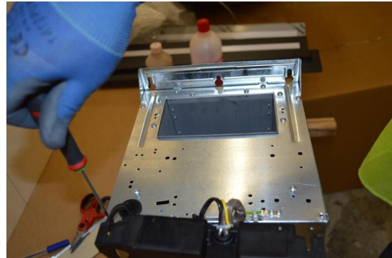
Remove 2 screws to remove the non-return valve above the motor unit / Rimuovere le 2 viti per rimuovere la valvola di non ritorno sopra l'unità motore
