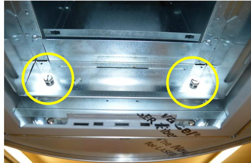
Fix the LOWER part of the hood to the structure with 4 screws from below and open service panel rotating 2 screws / Fissare la parte INFERIORE della cappa alla struttura con 4 viti dal basso e aprire il pannello di servizio ruotando 2 viti
