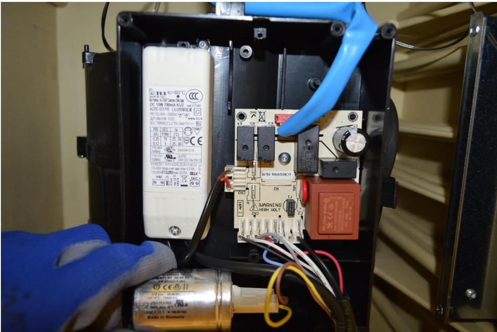
Disconnect the motor connections from the mainboard and from the capacitor / Disconnettere le connessioni del motore dalla scheda madre e dal condensatore
