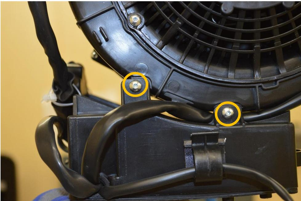
Unscrew n.2 screws and remove the mainboard box / Svitare 2 viti e rimuovere la scatola della scheda madre
