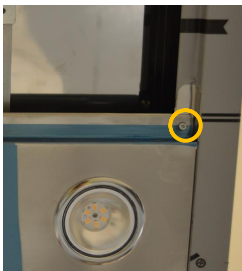
In order to unhook lamp support unscrew 2 screws / rimuovere 2 viti per sganciare il supporto lampada
