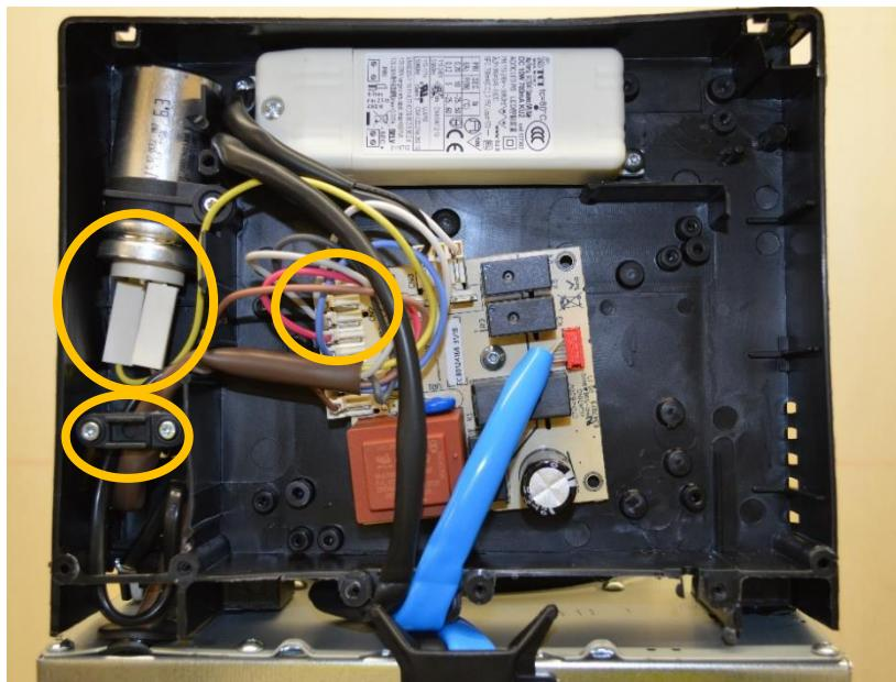
Disconnect motor connections from main board and capacitor / Scollegare i collegamenti del motore dalla scheda principale e dal condensatore
