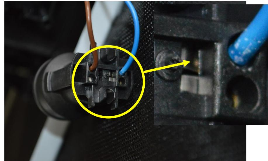
Unhook the lamps and use a small iron pin to disconnect wirings / Sganciare le lampade, inserire una spina d'acciaio nella fessura per disconnettere i cablaggi
