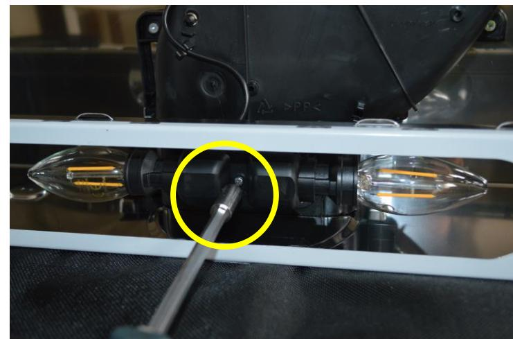
Remove plastic clip and remove lamp cover. Then remove the screw / rimuovere la clip in plastica e rimuovere la plafoniera. Successivamente rimuovere la vite
