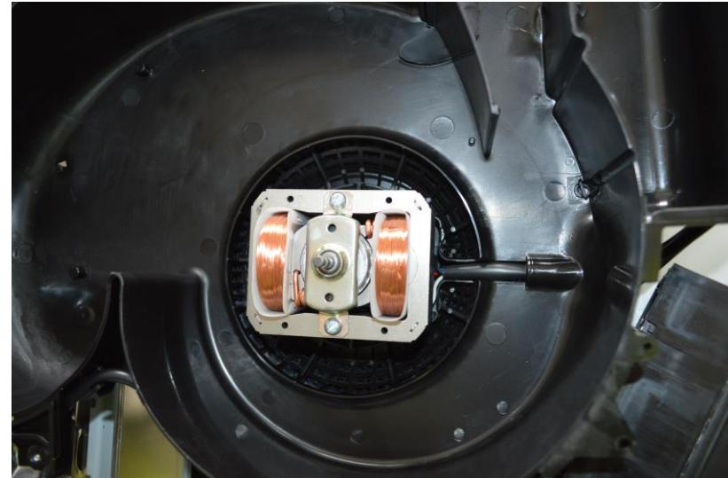
Unscrew the nut to separate fan wheel and motor / rimuovere il dado per separare girante e motore
