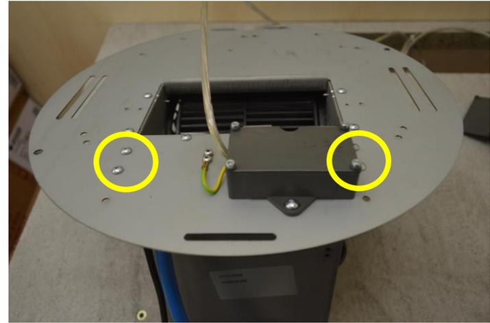
Lift up the motor support and unscrew 4 screws / Sollevare il supporto del motore e svitare le 4 viti
