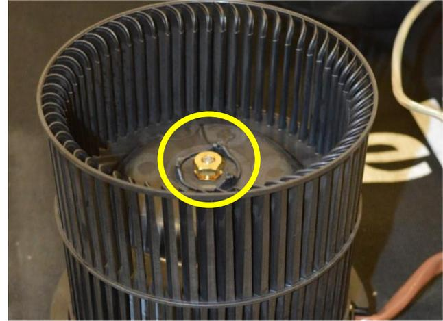
Unscrew the nut and replace the motor / rimuovere il dado per sganciare la girante e sostituire il motore
