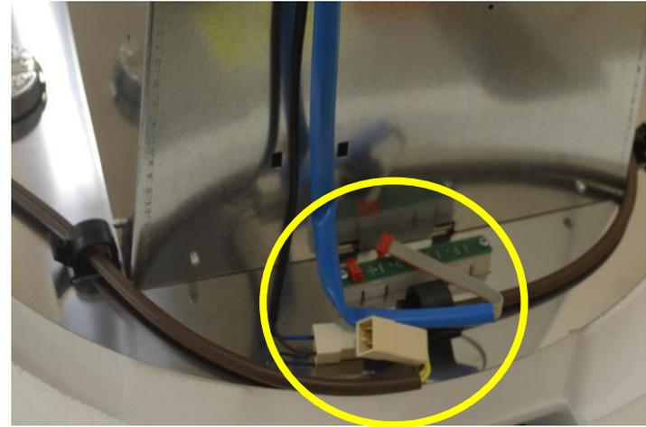
Unscrew all the perimeter screws. Disconnect the connections / Svitare tutte le viti perimetrali. Scollegare le connessioni
