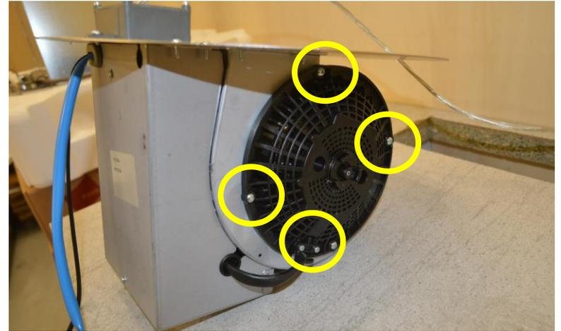
Disconnect motor connections from main board and capacitor. Unscrew 6 screws to open motor box / Scollegare i collegamenti del motore dalla scheda principale e dal condensatore. Svitare 6 viti per aprire la scatola del motore
