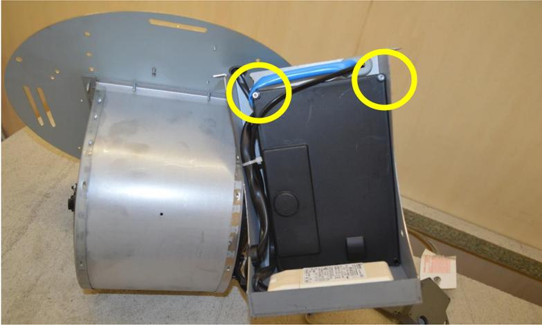
Unscrew 2 screws to open electronic box / Svitare 2 viti per aprire la scatola elettronica
