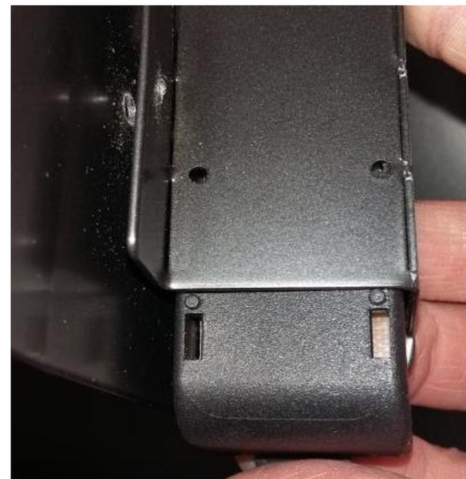
In order to remove odour sensor remove 2 screws and release cover / per rimuovere il sensore odori rimuovere 2 viti e aprire il coperchio
