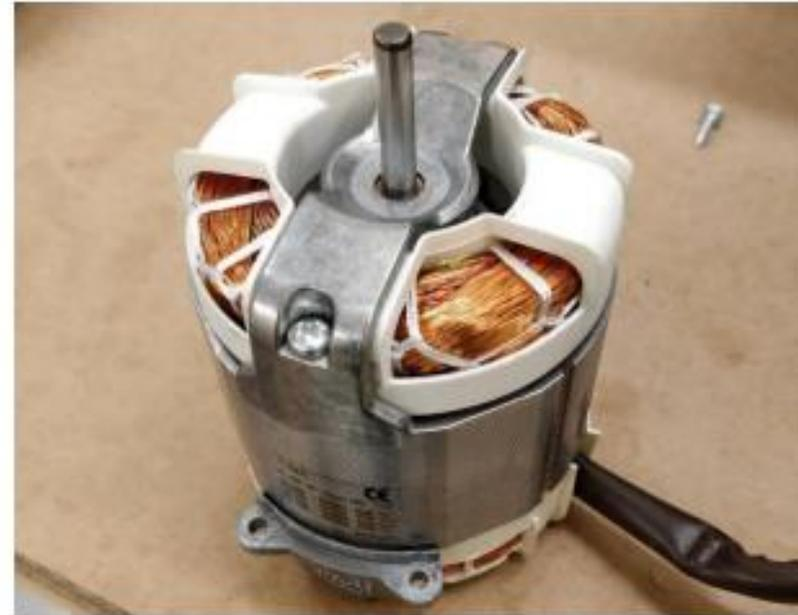
Unscrew 4 fixing screws and replace motor / Rimuovere le 4 viti e sostituire il motore
