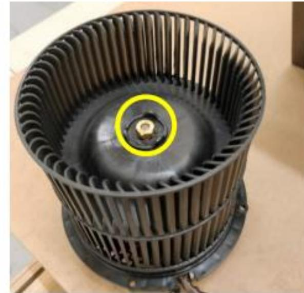
Unscrew 4 screws. Disconnect motor connection from Main board and from capacitor. Unscrew the nut to set free the impeller / Rimuovere le 4 viti del convogliatore. Disconnettere le connessioni del motore sulla scheda elettronica e dal condensatore. Allentare il dado per rimuovere la girante
