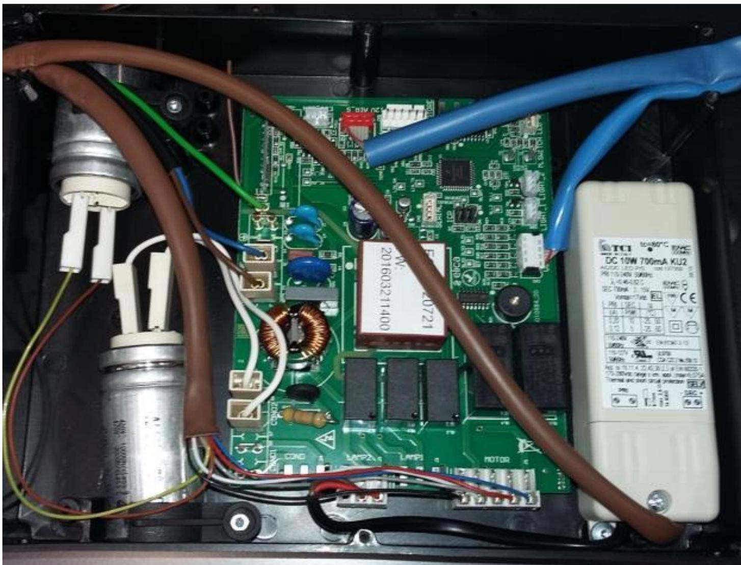
There are 2 capacitors, which allow low engine revs in the first speeds and high performance at maximum speed / sono presenti 2 condensatori, tale permettono bassi giri del motore nelle prime velocità ed alta prestazione alla massima velocità.
