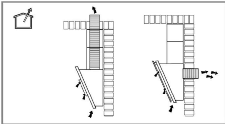
Duct Out version: with chimneys or with back aspiration / Versione aspirante: con camini o con back aspiration
