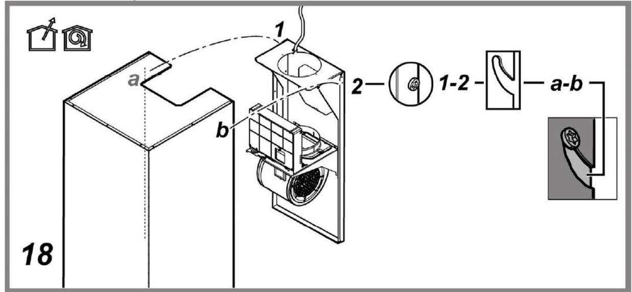
Unhinge the outer housing from fixing bracket / Sganciare l'alloggiamento esterno dalla staffa di fissaggio
