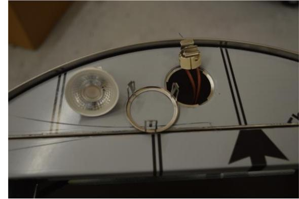
Lamp consists of 3 different parts: neon support; lamp; lampholder. Unhook the lamp from its seat and then remove also the lamp ring. / La lampada è composta da 3 parti diverse: supporto neon; lampada; portalampada. Sganciare la lampada dalla sua sede e quindi rimuovere anche l'anello della lampada.
