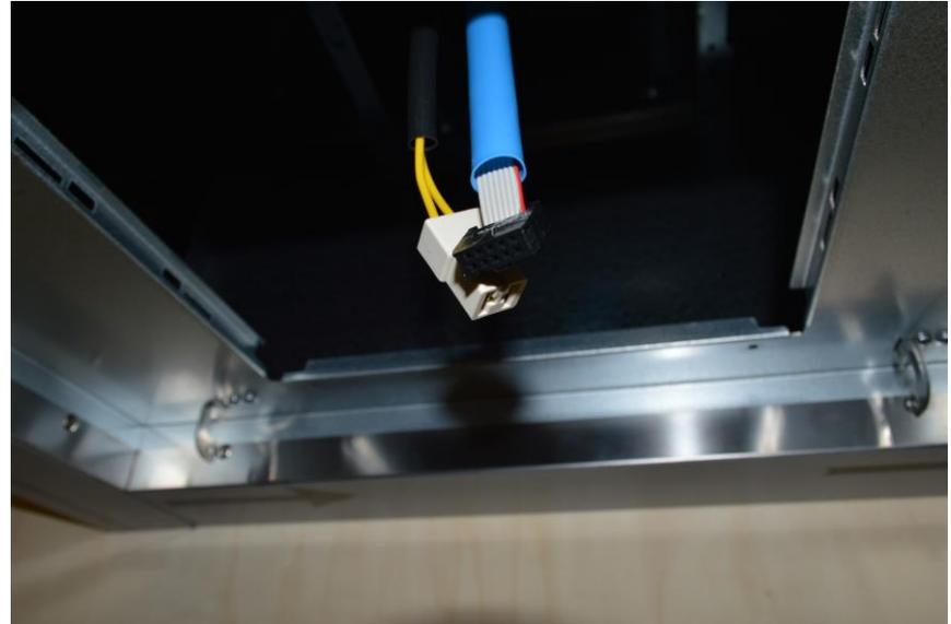
Disconnect wires of user interface and illumination / disconnettere I cablaggi del comando e dell'illuminazione
