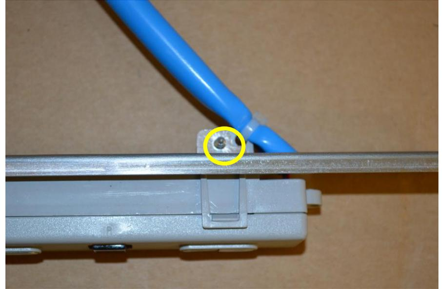
Disconnect wiring. When replacing the user interface take care to positioned it correctly on to the bracket, there is a small cut-out for the positioning and to fix the binder / Disconnettere il cablaggio. Quando si sostituisce l'interfaccia utente, assicurarsi di posizionarla correttamente sulla staffa, c'è un piccolo foro per il posizionamento e per fissarlo correttamente
