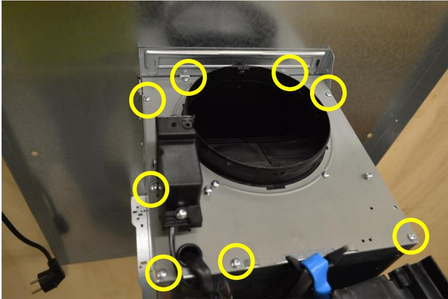
Unscrew all 8 perimeter screws and lift up the panel with motor / Svitare tutte le 8 viti perimetrali e sollevare il pannello con il motore
