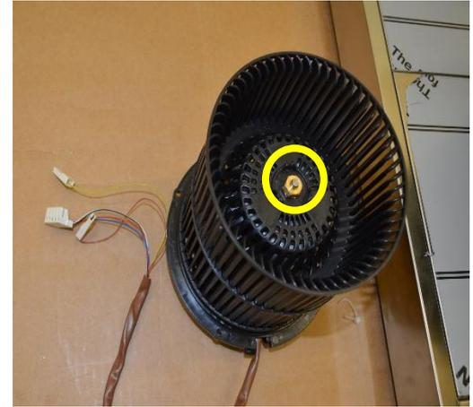
Unscrew 4 external screws and 4 motor screws. Remove Motor and unscrew fan wheel / Svitare 4 viti esterne e 4 del viti motore. Rimuovere il motore e svitare il dado della girante
