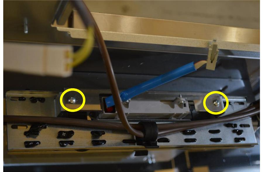
Remove outer housing and unscrew 2 screws the fixing support / Rimuovere l'alloggiamento esterno e svitare le 2 viti del supporto di fissaggio
