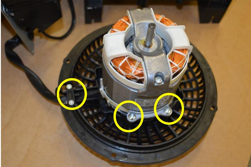
In order to separate motor from motor support unscrew 2 screws for the cable holder and 4 motor screws / Svitare 2 viti per il passacavo e 4 viti del motore per separarlo dal supporto motore
