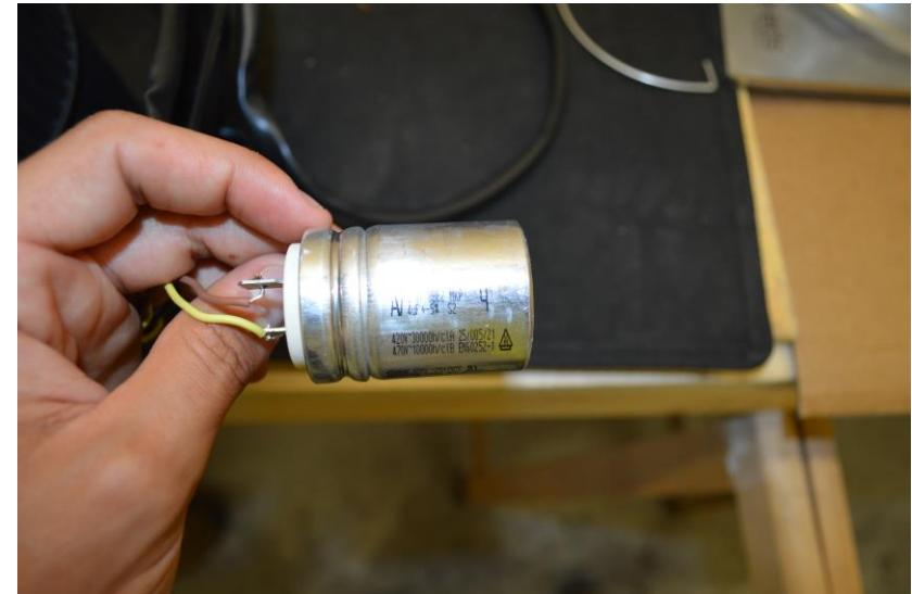
Disconnect capacitor / disconnettere il condensatore
