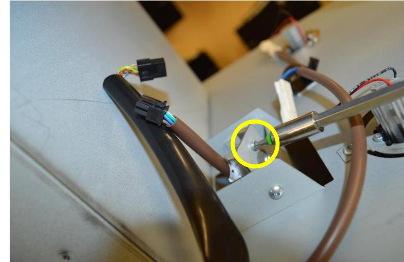
Disconnect wiring and remove screws / disconnettere il cablaggio e rimuovere le viti
