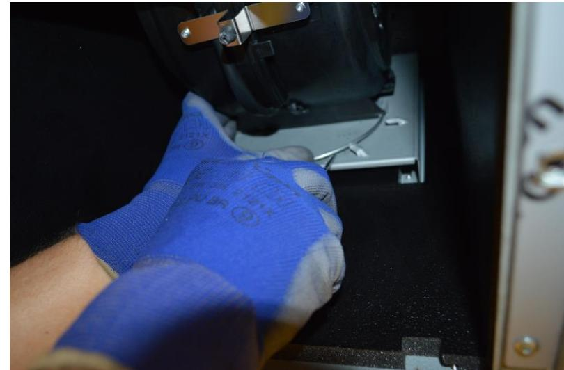
Disconnect motor wiring and releas fixing ring in order to drop down complete conveyor without dismounting the whole product from the ceiling / disconnettere connettore motore e sganciare l'anello di fissaggio per far scendere il convogliatore completo senza smontare il prodotto intero dal soffitto
