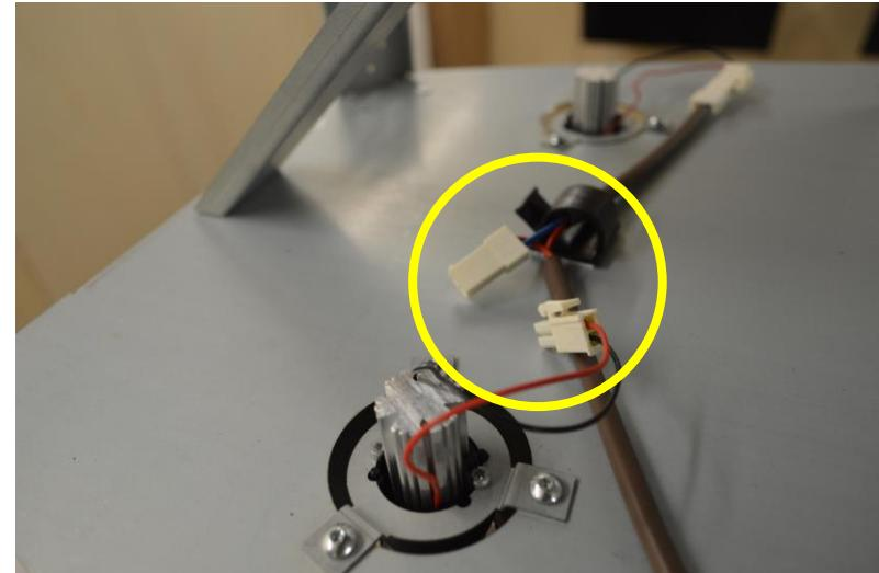
Remove 3 screws and disconnect wiring. Pull out lamp / rimuovere 3 viti e disconnettere il cablaggio. Estrarre la lampada
