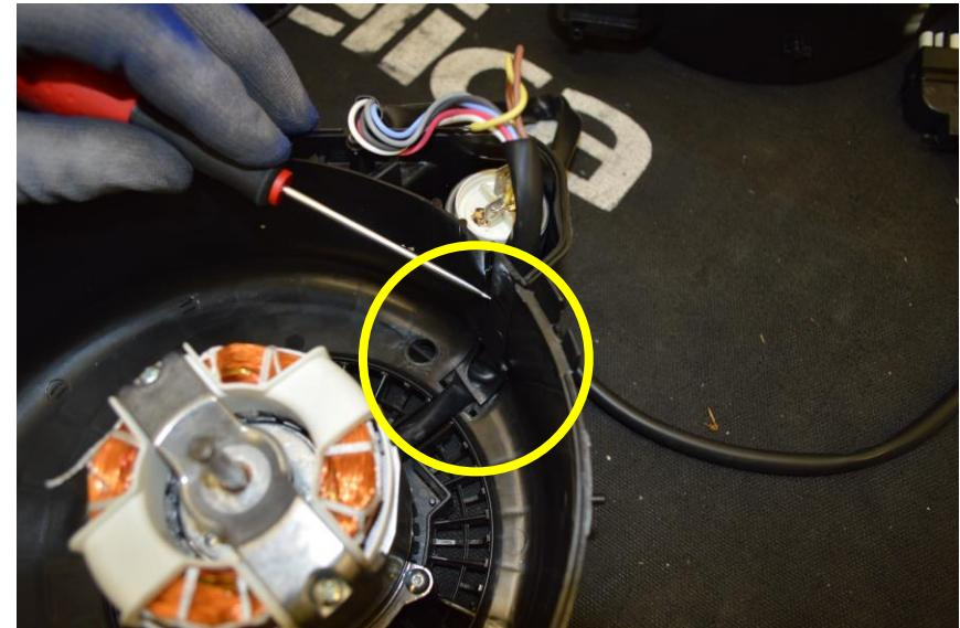
Remove the nut of fan wheel and remove cable holder / rimuovere il dado della girante e
