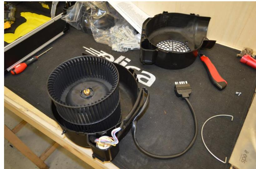
Open the fixing screws of the conveyor and separate left half and right half conveyor and remove 2 screws of metallic cable holder / Togliere le viti di fissaggio e separare la metà destra e sinistra del convogliatore e rimuovere 2 viti del passacavo in metallo
