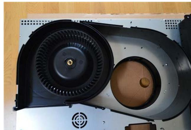
Hold the fan wheel in order to not deform it during the unscrewing. / Tenere la ruota della girante per non deformarla durante lo svitamento.
