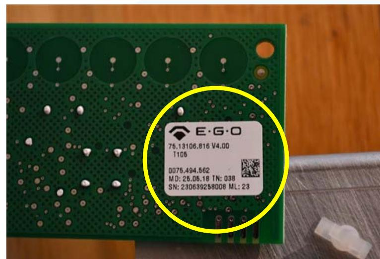
Spare part replacement: remove the TOUCH CONTROL MASTER / Sostituzione pezzo di ricambio: rimuovere il T.C. MASTER
