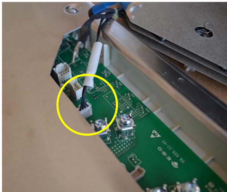
Spare part replacement: remove the INDUCTION PLATE / Sostituzione pezzo di ricambio: rimuovere l'INDUCTION PLATE (il modulo di induzione)
