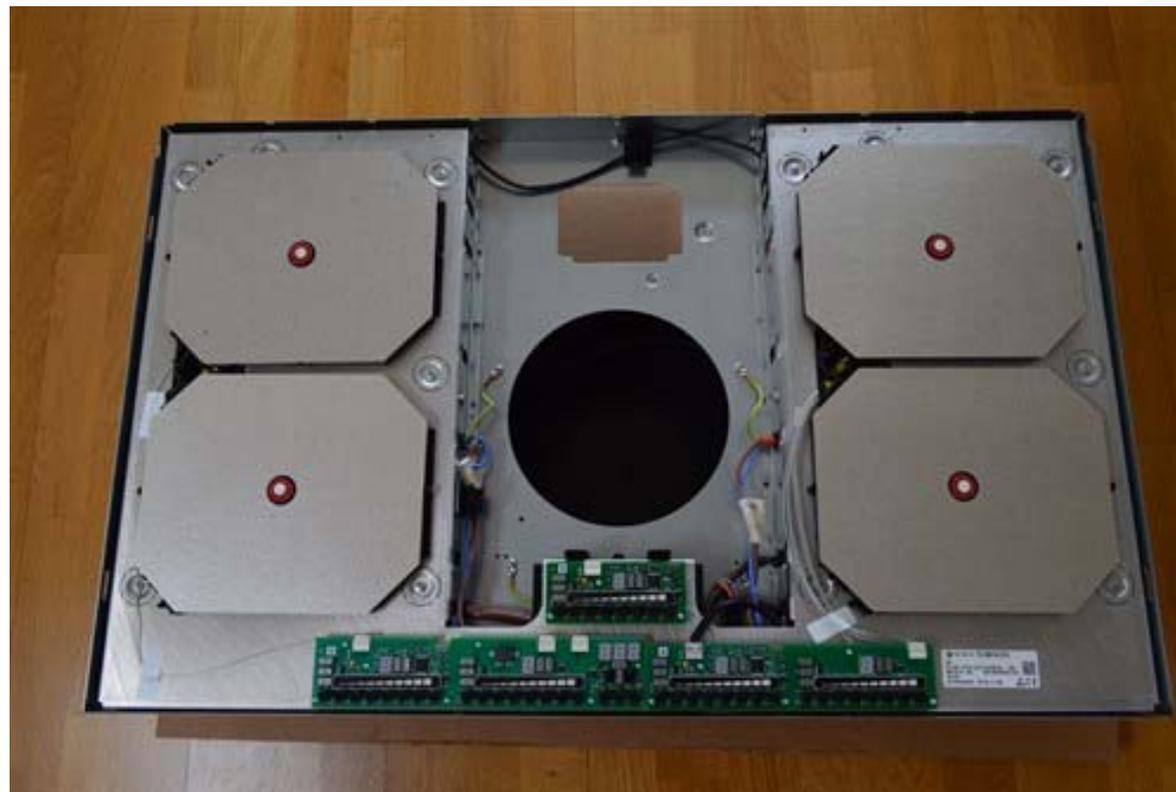
Spare part replacement: remove the INDUCTION PLATE / Sostituzione pezzo di ricambio: rimuovere l'INDUCTION PLATE (il modulo di induzione)
