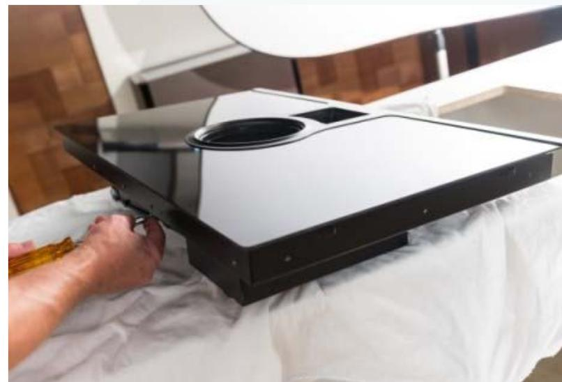
Spare part replacement: remove the glass / Sostituzione pezzo di ricambio:
