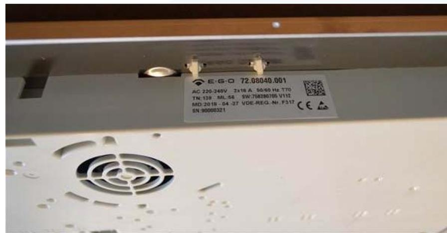
Spare part replacement: remove the INDUCTION PLATE / Sostituzione pezzo di ricambio: rimuovere l'INDUCTION PLATE (il modulo di induzione)
