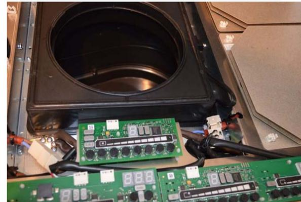
Spare part replacement: remove the COMPLETE SLIDER / Sostituzione pezzo di ricambio: rimuovere il COMPLETE SLIDER
